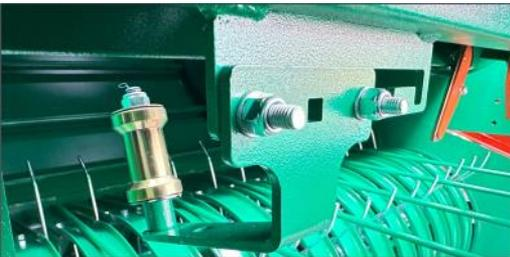
**Регулировка ширины обмотки рулона:** для прессования скользких культур, внедрена ступенчатая регулировка ширины обмотки шпагатом рулона. Смещение ограничителей к центру или к краю, позволяет настроить обмотку на краях рулона, чтобы не соскальзывал шпагат с краёв.
