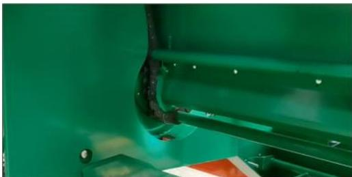
**Не перескакивает и не заклинивает прессующий механизм:** увеличен зазор в месте установки ведущего вала передней камеры в момент попадания между цепью и зубом ведущей звёздочки веток, палок или сломанных спиц граблей не происходит заклинивания в момент перескакивания цепи, и она самоустанавливается на место в 95% таких случаев.
