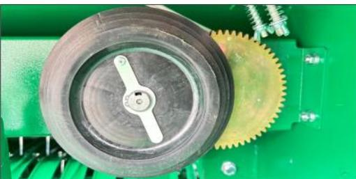
**Металлическая шестерня обматывающего аппарата:** обеспечивает надёжную работу аппарата, даже при попадании узлов в шпагате или его запутывании, у аналогичной техники других производителей используется пластиковая.
