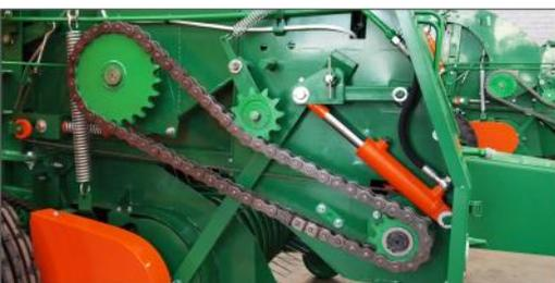
**Качественные приводные цепи:** на приводах цепи из качественных углеродистых сталей, и имеют высокий ресурс работы, в суровых условиях эксплуатации (рекомендуется ежедневная смазка цепей). На всех цепях нанесён логотип нашего завода УСМ.
