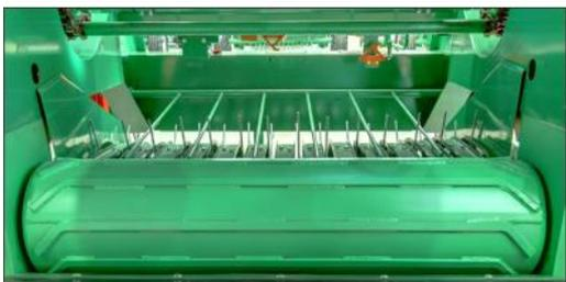
**Валец немецкой конструкции:** приёмный валец имеет рёбра специальной формы, исключая проскальзывание рулона при его формировании, за счет этого увеличилась плотность прессования рулона. Сформированный рулон прессуемой массы внутри камеры не проскальзывает и не останавливается, тем самым не забивается подборщик.
