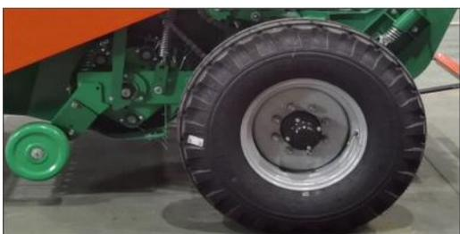
**Ходовые колёса:** колеса и ступицы применяются от прицепа 2ПТС-4 на 8 шпилек, имеют взаимозаменяемость с тракторным прицепом.
