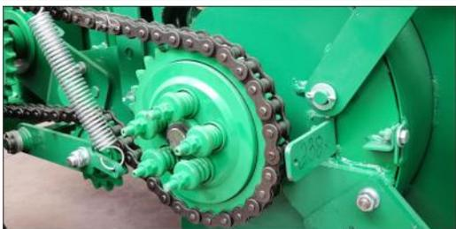
**Надёжная защита от перегрузок подборщика:** на подбирающем механизме установлена фрикционная предохранительная муфта, защищающая агрегат от перегрузок, предотвращая выход из строя в момент попадания инородных предметов в подбирающий механизм.
