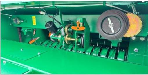
**Новый тип обматывающего аппарата на одну нитку:** имеет равномерную качественную обмотку шпагатом, с новой надёжной и простой конструкцией привода. Начинается обмотка и обрезается шпагат по центру, обматывается 2-3 витка по краям рулона и равномерно стягивается рулон шпагатом.
