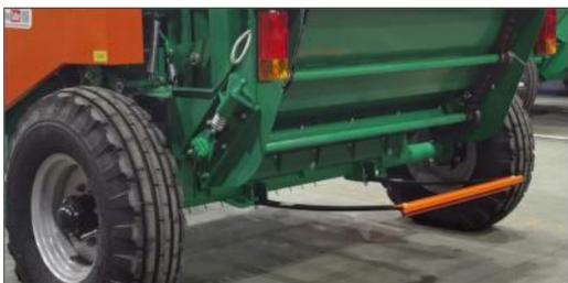
**Сокращение времени выгрузки рулона:** скатная доска, обеспечивает отбрасывание рулона за траекторию закрывания камеры, экономия 15-20 секунд при выгрузке каждого рулона. Не требуется отъезжать назад при выгрузке готового рулона, скатная доска из рессоры имеет высокую надёжность и простоту конструкции.
