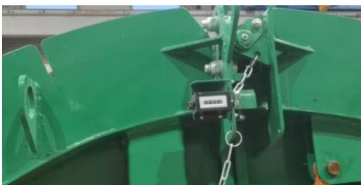
**Автоматический подсчет рулонов:** установлен механический счётчик рулонов, отсчитывающий в момент выгрузки рулона количество циклов открывания задней камеры.
