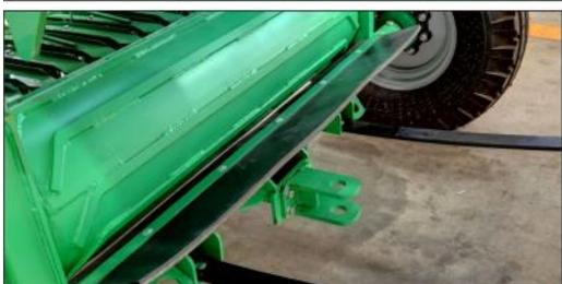
**Минимальные потери мелкого сена и соломы:** установлен защитный резиновый кожух между вальцом и задней камерой, исключает потери мелкой убираемой массы. Не просыпается мелкое сено за пресс-подборщиком как на аналогичной технике, снизу между вальцом и прессующим механизмом.
