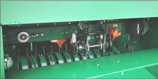
**Обматывающий аппарат на две нитки:** имеет высокую производительность и равномерную качественную обмотку шпагатом, привод одновременно подаёт два шпагата, два поводка одновременно движутся влево и направо тем самым сокращается время обмотки в 2 раза. Начинается обмотка и обрезается шпагат по центру, обматывается 2-3 витка по краям рулона и равномерно стягивается рулон шпагатом.
