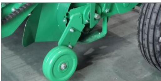
**Копирование рельефа подборщиком:** новый вид копирующих колёс имеют большой диапазон регулировок по высоте. Они настраиваются по сетке регулировочных отверстий на нужную высоту для копирования рельефа, в верхнем положении могут работать как отбойник;
