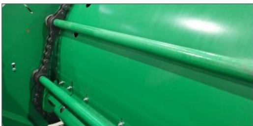
**Прессующий механизм:** усиленная спеццепь шагом 38,1 мм и скалками 20 штук из круга высокоуглеродистой стали (не из трубы) диаметром 40 мм.
