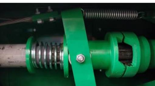
**Три закалённых зуба на размыкателе:** на приводе установлена кулачковая полумуфта из высокоуглеродистой стали с закалёнными тремя зубьями, что даёт высокую долговечность в эксплуатации (у аналогов 2 зуба без термообработки).
