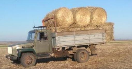
**Удобная перевозка рулонов:** габаритные размеры рулонов диаметр 1,1 м и ширина 1,2 м, позволяют перевозить на любом виде транспорта, прицеп легкового автомобиля - 2 шт., газель - 8 шт., ГАЗ 53 - 14 шт., Камаз сельхозник 16 шт., Камаз бортовик 6 метров 20 шт., тракторный прицеп 2ПТС-4 - 10 шт., еврофура - 40-42 шт.
