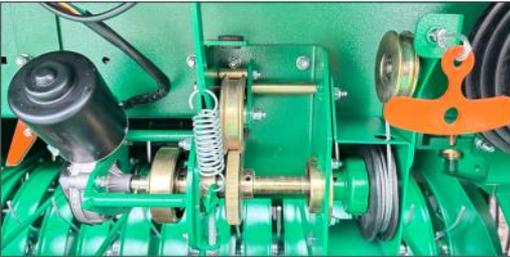
**Удобный привод обматывающего аппарата:** имеет электрический и механический привод запуска обмотки шпагатом, запускается с пульта управления нажатием кнопки или подёргиванием механического привода из кабины трактора. При достижении настроенной плотности прессования подается световой и звуковой сигнал на пульт управления механизатору.
