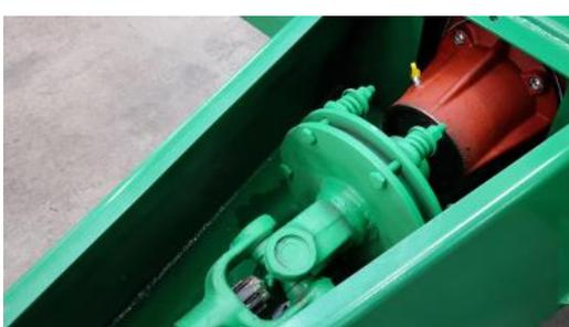
**Надёжная защита от перегрузок привода:** перед редуктором установлена фрикционная предохранительная муфта, защищающая агрегат от перегрузок, предотвращая поломку техники в момент попадания инородных предметов в камеру прессования. У аналогичных машин предохранительным устройством служит срезной болт, что не всегда удобно при эксплуатации.
